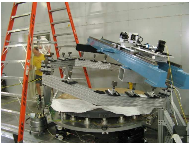
Abb. 33: Test des 1,6m-Spiegels des NST © Juli 2007, Steward Observatory Mirror Lab; BBSO
